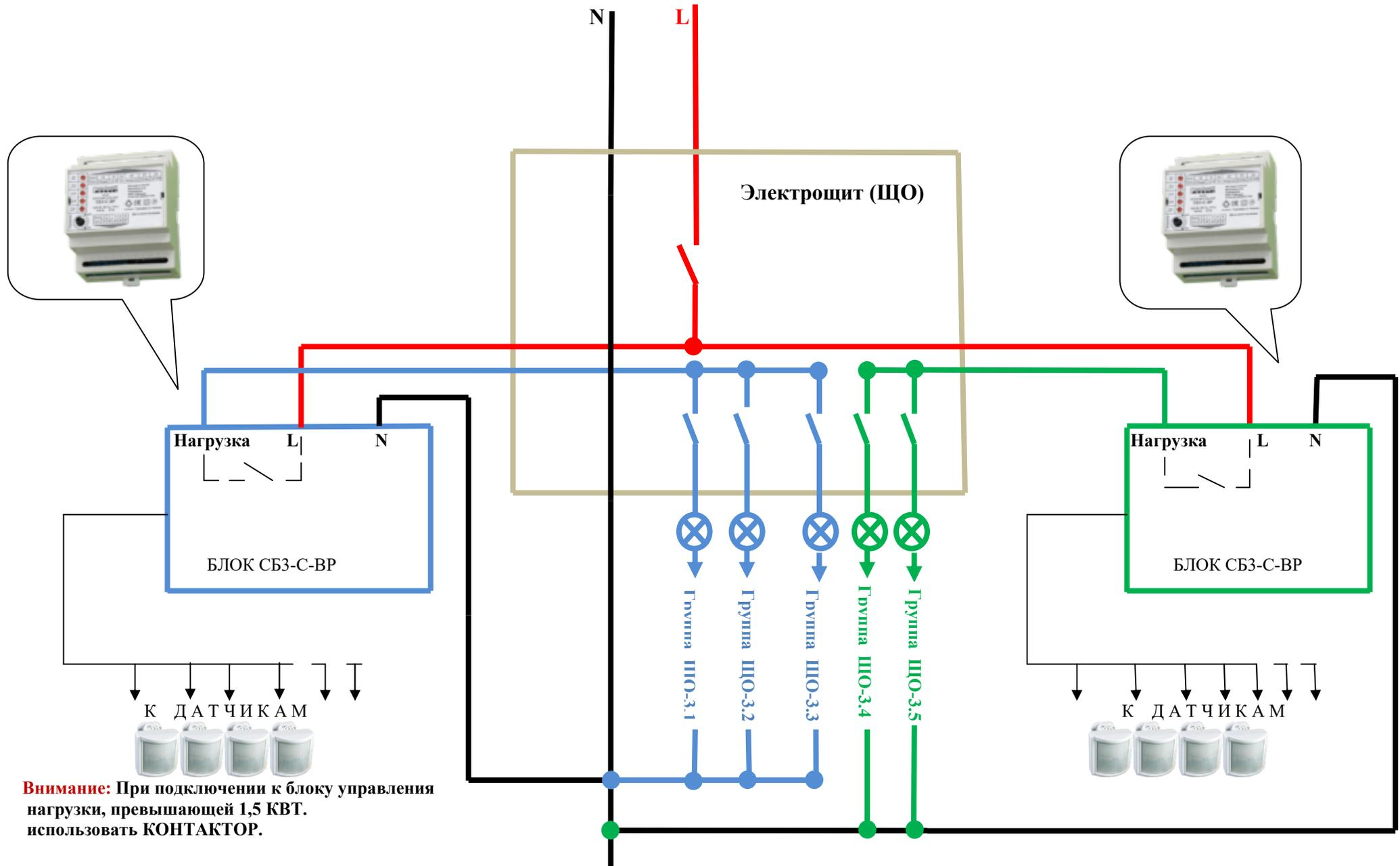
**Внимание:** При подключении к блоку управления нагрузки, превышающей 1,5 кВт. использовать КОНТАКТОР.
